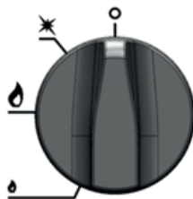
Rysunek 6. Ustawienie pokręta w którym ma miejsce całkowite odcięcie dopływu gazu do palnika.
