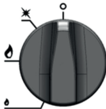
Rysunek 6. Ustawienie pokręta w którym ma miejsce całkowite odcięcie dopływu gazu do palnika.
